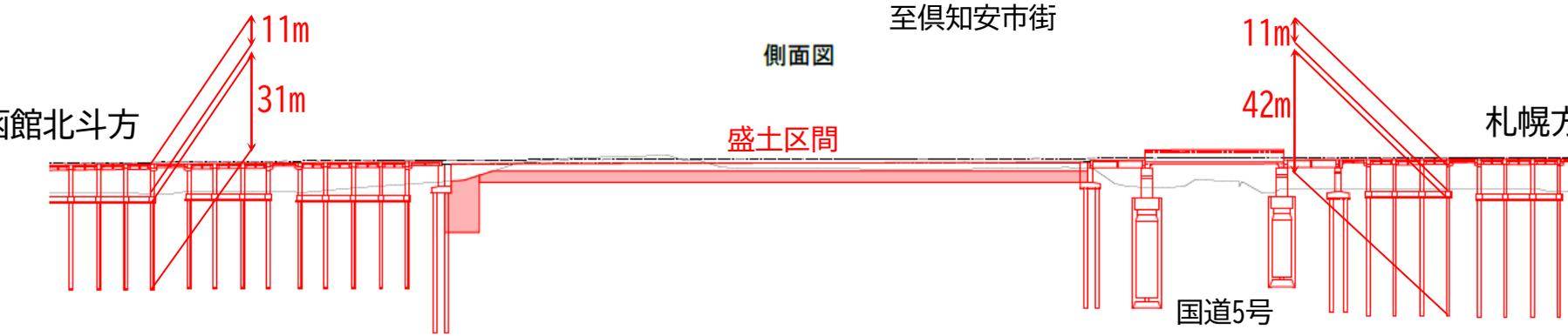
国道5号より市街地側の一部区間は、地形の関係で高架橋を構築せず、盛土の上にコンクリート路盤等を設置し、その上に新幹線のレールを敷設します。
