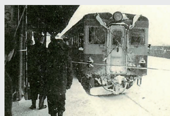
◀ ディーゼル機関車 蒸気機関車が廃止され、軽油で発電機を回し、その電力で走るディーゼル機関車が配置された
