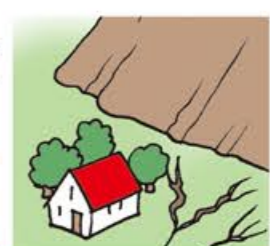
地面にひび割れができる
