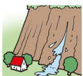
斜面から水がふき出す
