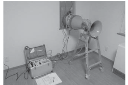
△建物の気密性を測る気密測定試験の様子です。くっちゃん型住宅では気密の基準値を設定しているのも特徴の一つです。
